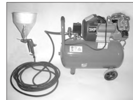
Рис. 1. Мобильная установка для лабораторного торкретирования
